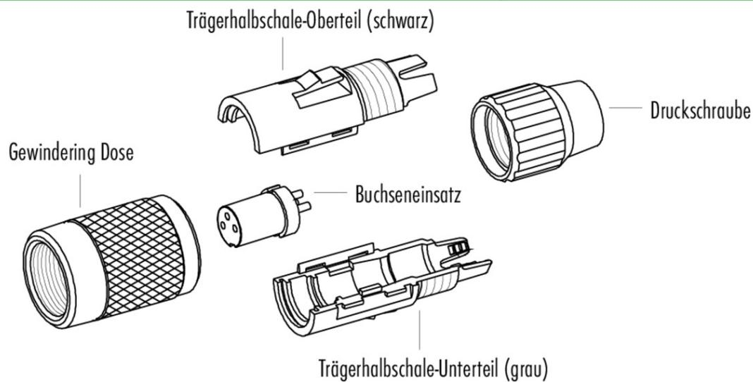
**Achtung:** max. Drehmoment des Gewinderings im Flanschsteckverbinder: 50cNm (handfest)
