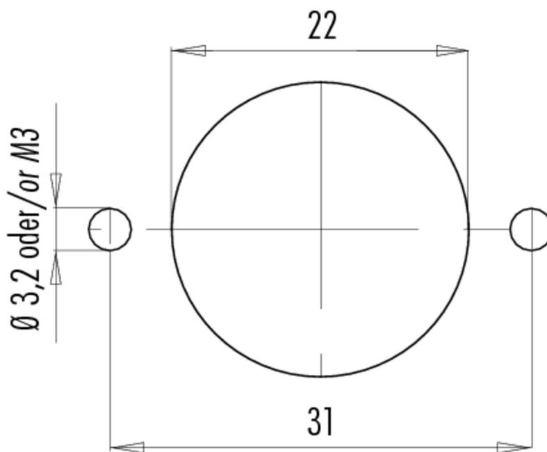
Description du produit **Contacts: 6+PE, connecteur mâle coudé PG 11, avec homologation VDE, SEV et UL, à souder**
